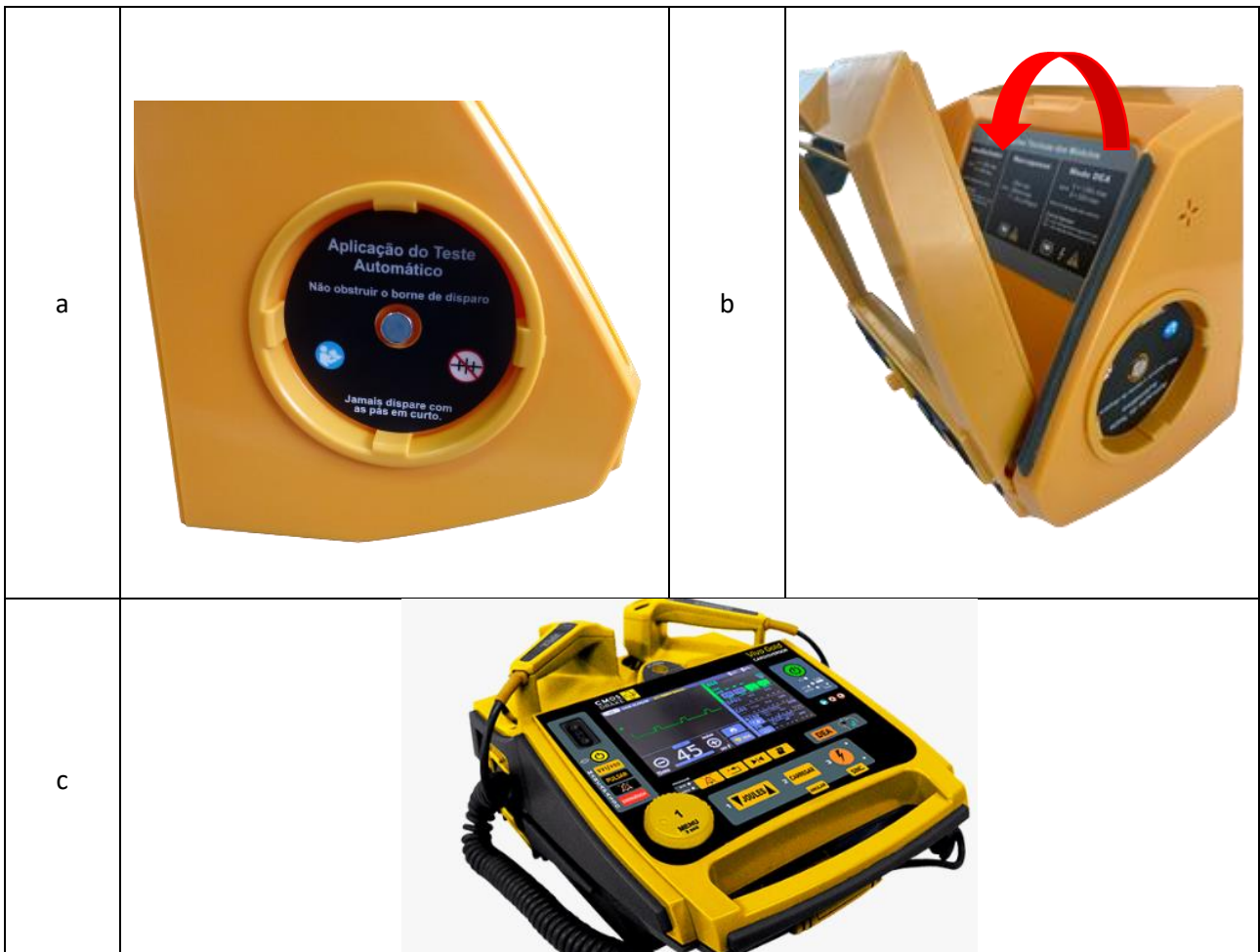
Figura 02 – Painel lateral da Família de Cardioversores Cardio Family. Legenda: a – alojamento das pás de choque permanentes do Vivo Star; b – mecanismo laptop do Vivo Star; c – painel lateral do Vivo Gold com a presença da entrada USB.
