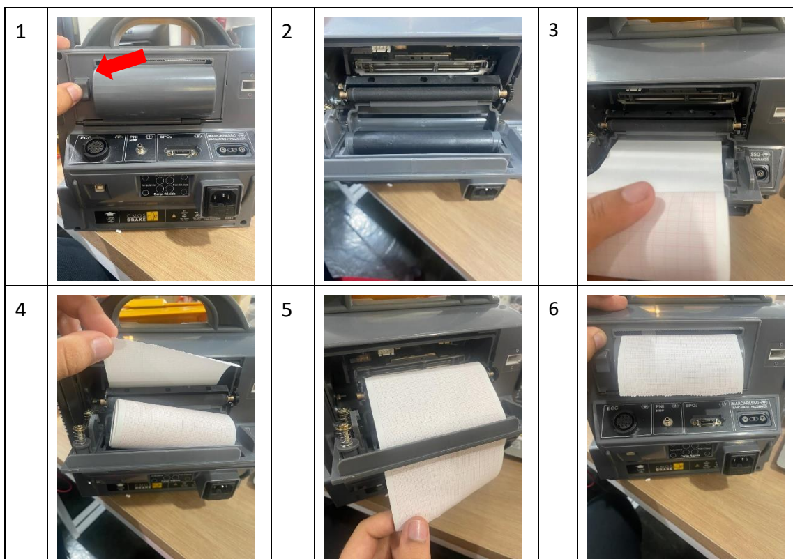
Figura 29 – Sequência de inserção de papel termossensível do Cardioversor Vivo Star.
