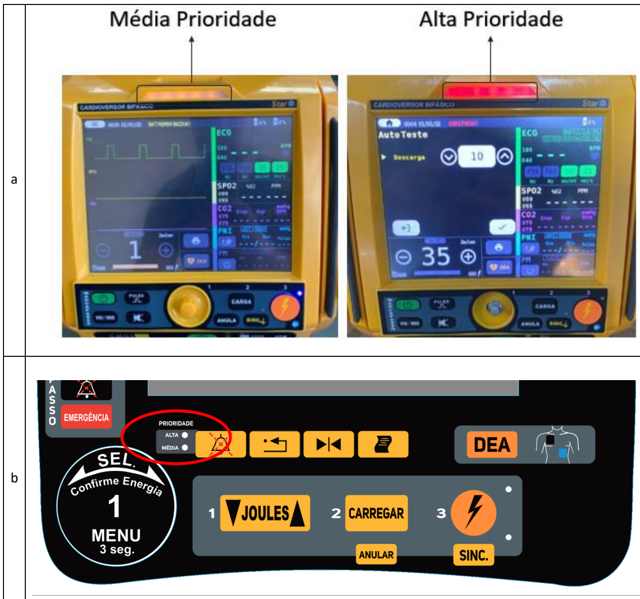
Figura 12 – Local dos Leds de alarme. Legenda: a - led do Cardioversor Vivo Star; b – led do Cardioversor Vivo Gold.
